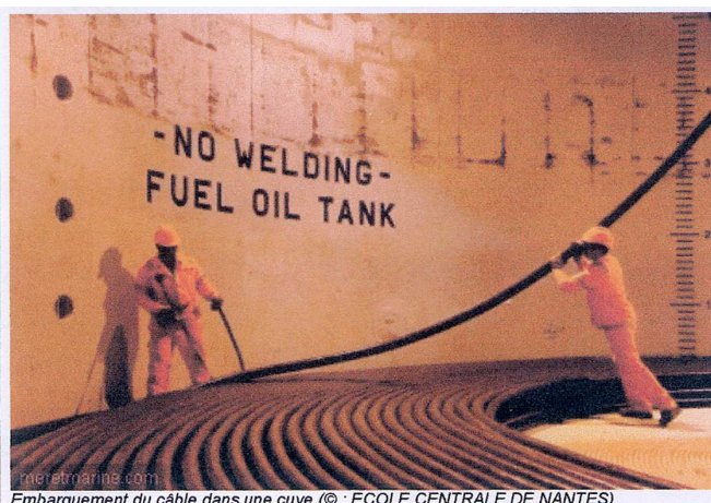
Embarquement du câble dans une cuve (© : ECOLE CENTRALE DE NANTES)
